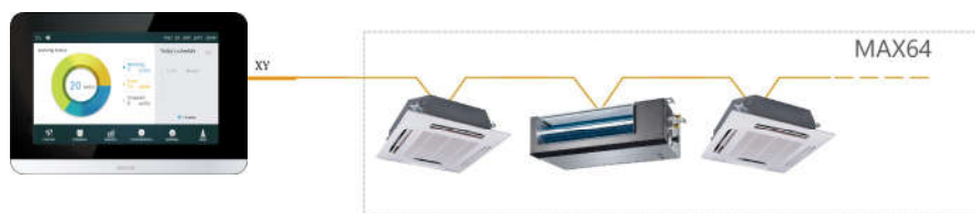
Obrázek 7b: Připojení centrálního ovladače k vnitřním jednotkám (první generace AC/DC vnitřních jednotek)
